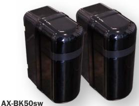
Barriera perimetrale ad infrarosso attivo (AIR) con portata fino a 50 metri in esterno. Doppia ottica, con tecnologia SMA (Single Man Alignment) per allineamento facilitato TX-RX (Trasmettitore-Ricevitore). Grado di protezione IP66, contro polvere e getti d'acqua.
